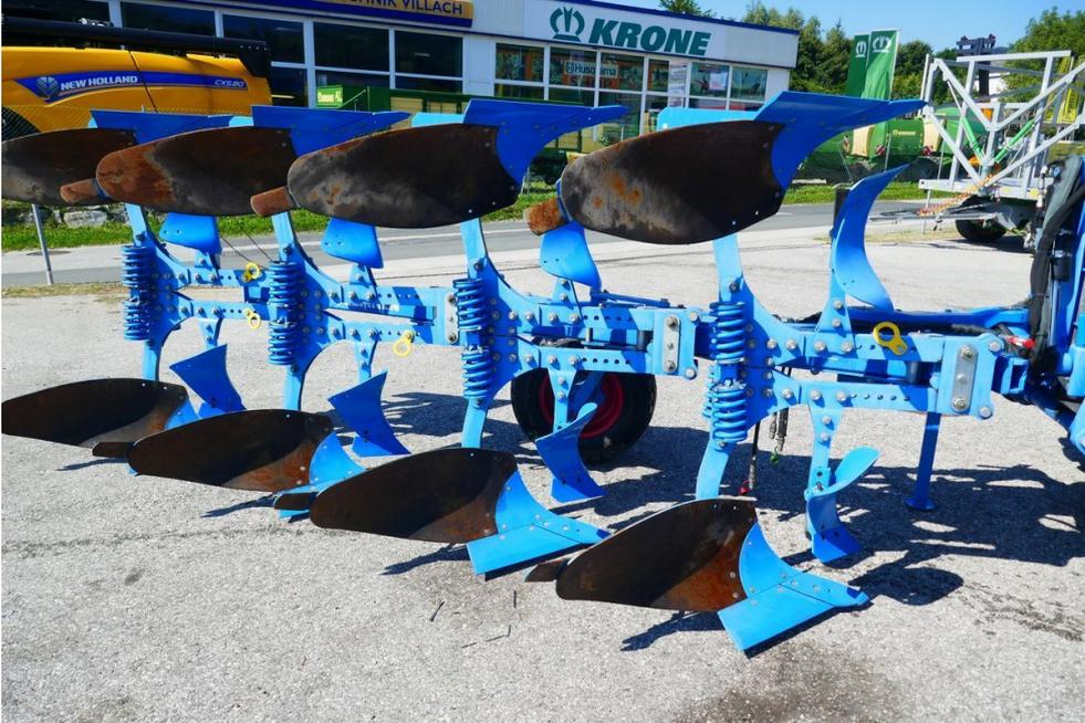
Lemken 4 Schaarpflug Juwel 7 M V X 4 L 100 mit mech. Steinsicherung, hydr. Rahmeneinschwenkung, Körperform Dural B35, Düngereinleger, Rahmenhöhe 80 cm, Pendelstützrad gedämpft 10.0/75-15,3, Verschleißteile neu bestückt, Vorfühmaschine 2021, prompt verfügbar.
