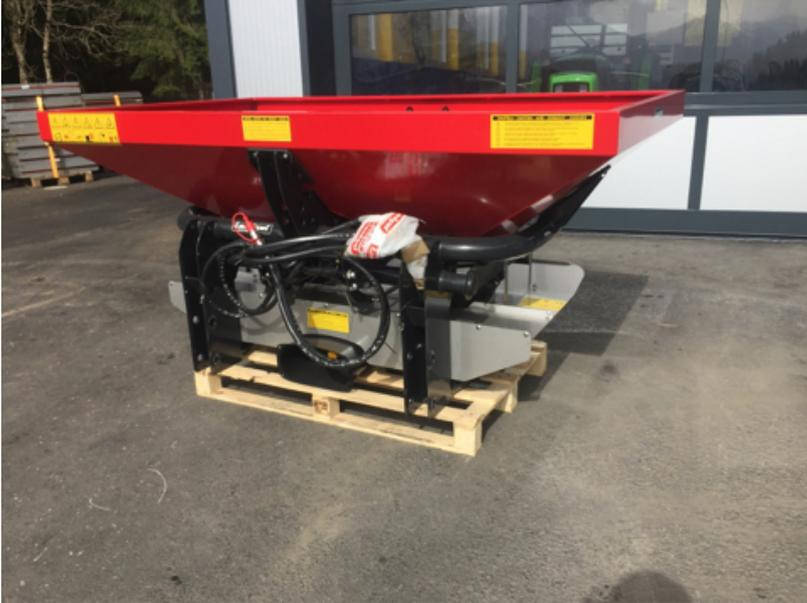
Zweischeiben-Mineraldüngerstreuer mit VIBRO-System, 600 Liter, Trichter+Rahmen pulverbeschichtet, Streuscheiben Streuflügel und Turbogehäuse aus Edelstahl, hydr. Bedienung und Gelenkwelle.
