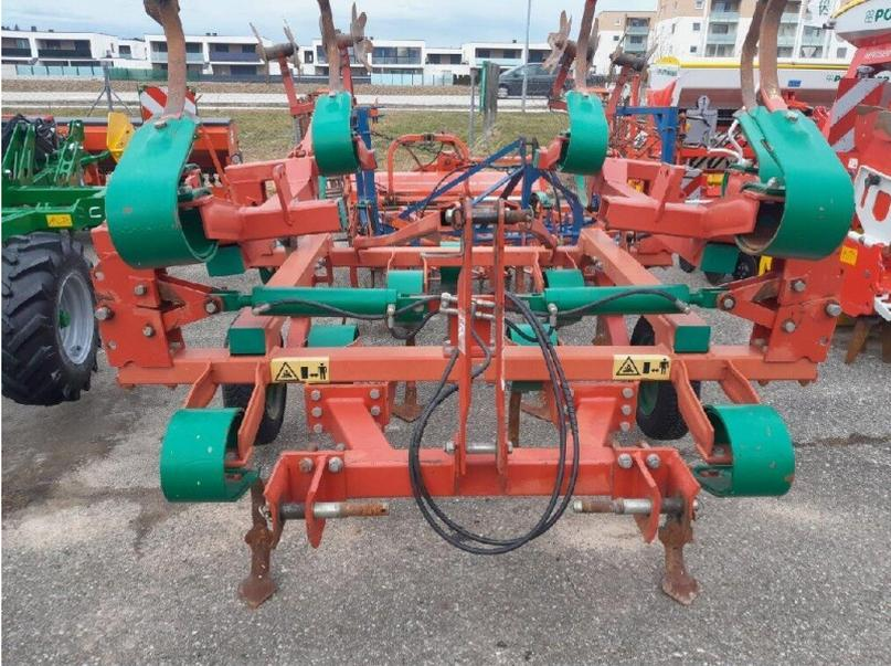
3m Arbeitsbreite, 4 Balkig mit 15 Zinken, höhenverstellbare Stützräder,
