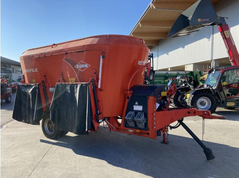
Kuhn Profile 1670, Austragung 2x rechts & 1x links, mit WWGW, Kuhn Electronic Concept KDW 340.
