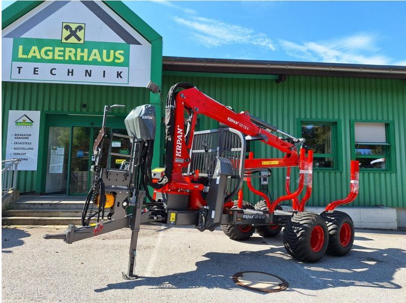
Der Anhänger hat einen stabilen Doppelrahmen. Die Lenkdeichsel mit zwei Zylindern ist um 40 Grad in beiden Richtungen lenkbar. Der Anhänger wird hydraulisch über alle 4 Räder gebremst. Serienmäßig verfügt der Anhänger auch über eine Verlängerung der Ladefläche, womit die Ladung von langen Stämmen ermöglicht wird.
