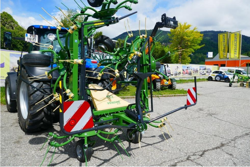
Krone Kreiselheuer Vendro 790 Hydro mit 6 Kreisel mit 7 Zinken pro Kreisel, hydraulische Grenzstreueinrichtung, neuen dreidimensionalen geformten Krone OptiTurn Zinken mit 3D Effekt für beste Streuqualität, Schwenkbock mit einstellbaren Dämpferstreben, Tastrad, Gelenkwelle, Abstellstützen, Ausstellungsmaschine, prompt verfügbar.
