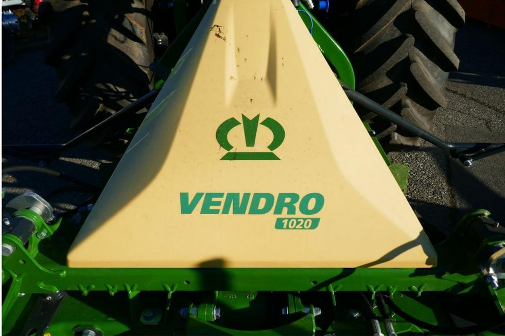
Krone Vendro 1020 Kreiselzettwender, 10-Kreisler, Arbeitsbreite 10,2 m mit Dreipunktanbau, Tastrad, hydr. Dämpfungsstreben, 10 Kreisel mit je 5 Zinkenarme, hydr Aushebung DW, OctoLink Klauenkupplung, Zinkenverlustversicherung, Abstellkonzept mit 2 Abstellfüße, hydr. Grenzstreueinrichtung, Gelenkwelle, Streuwinkelverstellung, Kreiselgetriebe in Fließfett, LED - Beleuchtung, Ausstellungsmaschine, günstige Finanzierungsmöglichkeit, prompt verfügbar.
