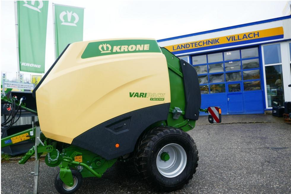
Krone VariPack V165XC Plus Profiriemenpresse, variabel von 0,8-1,65 m Durchmesser, 26-Messer Schneidwerk mit hydraulischer Messerschaltung und hydraulisch absenkbar messerboden sowie Einzelmessersicherung, Integralrotor mit Zwangsschnitt für beste Schnittqualität, automatische Schmierung von Ketten und Lagern, Ballenauswerfer, Komfort Bordelektronik ISOBUS-fähig, Druckluftbremse, Bereifung: 600/50-R22.5, LED Arbeitsbeleuchtung, günstige Finanzierungsmöglichkeit für Österreich, prompt lieferbar.
