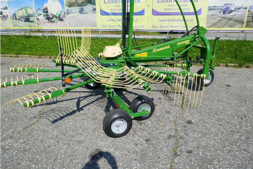
Krone Swadro S 420 Einkreiselschwader mit 13 Armen, 5 klappbaren Zinkenarmen, Tandemachse, vorderes Tastrad, Schwenkbock mit hydraulischen Dämpferstreben, hydraulisch klappbar und verschiebbares Schwadtuch, Schutzbügel, Gelenkwelle, Lieferung nach Vereinbarung
