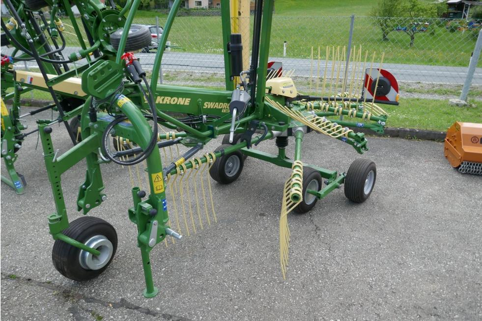
Krone Swadro S 380 Einkreiselschwader, 5 klappere Zinkenarme, 4 Doppelliftzinken pro Arm, Tandemachse, vorderes Tastrad, Schwenkbock mit mechanischen Dämpferstreben, hydraulisch klapp- und verschiebbares Schwadtuch (DW), Ausstellungsmaschine, Optional: Beleuchtung, Standort: Lieserbrücke, prompt verfügbar.
