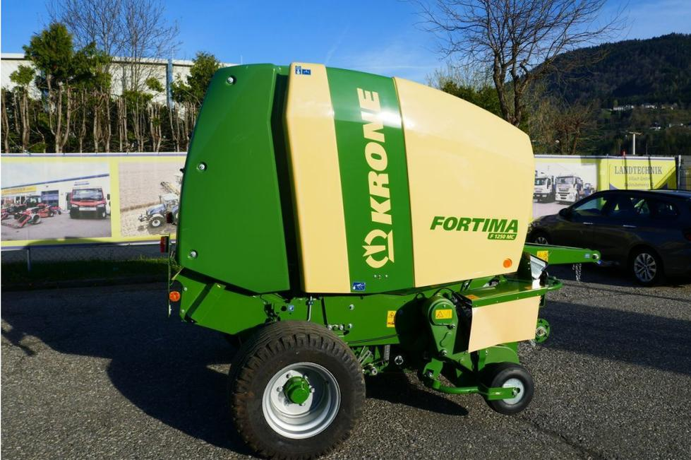
Krone Fortima 1250 MC, Festkammerpresse, 17 Messerschneidwerk, breite Pick-up, mit Rollenniederhalter, Gummiträger, Netzbindung, Komfortbedingung DS 500, zentral Schmierung, hydr. Bremse, Bereifung 19/45-17, Weitwinkelgelenkwelle, sehr leichtzügige Maschine, günstige Finanzierungsmöglichkeit, Lieferung nach Vereinbarung.
