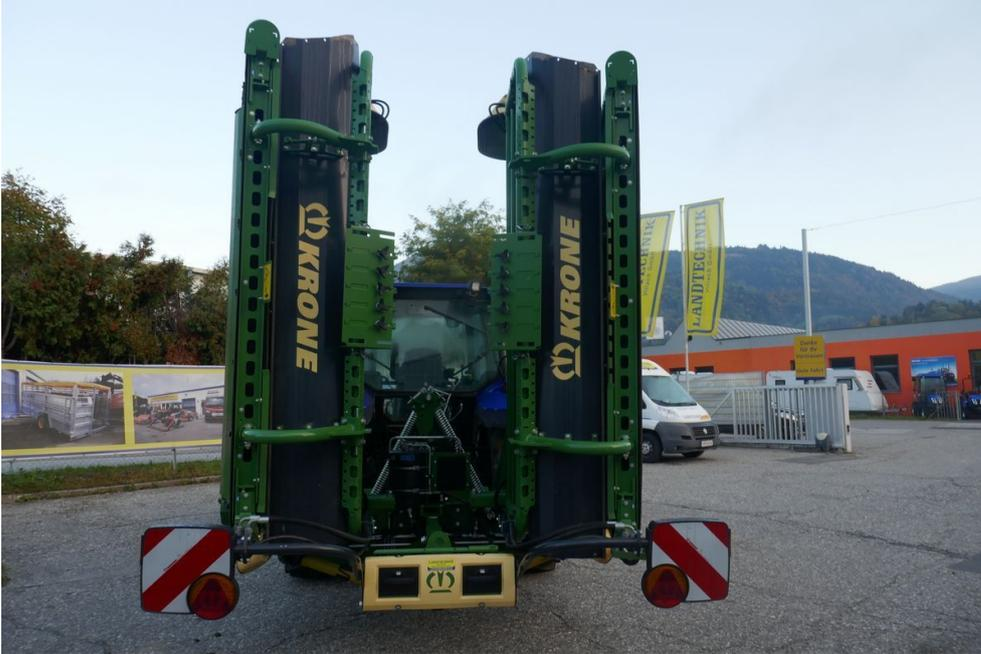
Krone Heckmähkombination EC B 870 CV - mit Hochleistungsstahlzinkenaufbereiter und Querförderbänder, Leistungsbedarf ab ca. 150 PS Zapfwellenleistung, elektrische Komfortbedienung, Vorführmaschine, prompt verfügbar!
