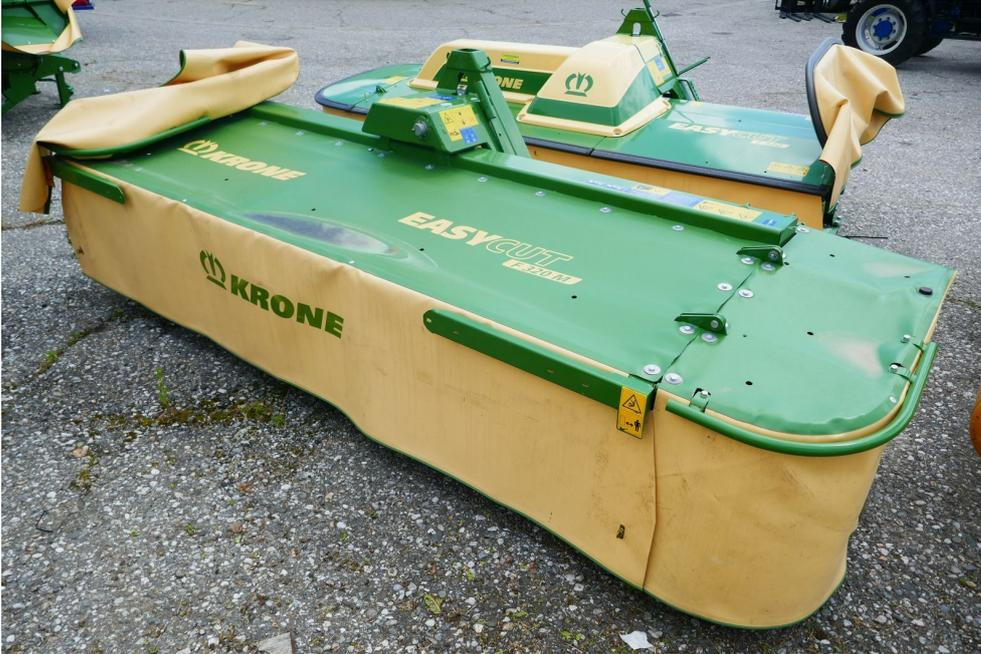
Leichtes Krone Frontscheibenmäherwerk F 320 M, Eigengewicht ca. 680 kg, Anbau mit Weiste-Dreieck, Klingenschnellverschluss, Mäh Scheibensicherung SafeCut, Gelenkwelle, Teleskopoberlenker mit Entlastungsfedern, Ausstellungsmäherwerk, prompt verfügbar.
