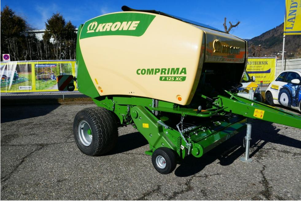
Krone Comprima F 125 XC Profi, Festkammerpresse, mit NovoGrip System, 17 Messerschneidwerk, absenkbarer Messerboden mit Einzelmesser Sicherung, breite Pick-Up mit Rollenniederhalter, Gummitasträder, autom. Kettenschmierung, Druckluftbremse, Bereifung 500/50/17, Mit ISOBUS Anschluss ohne Monitor, Weitwinkelgelenkswelle, günstige Finanzierungsmöglichkeit, prompt lieferbar.
