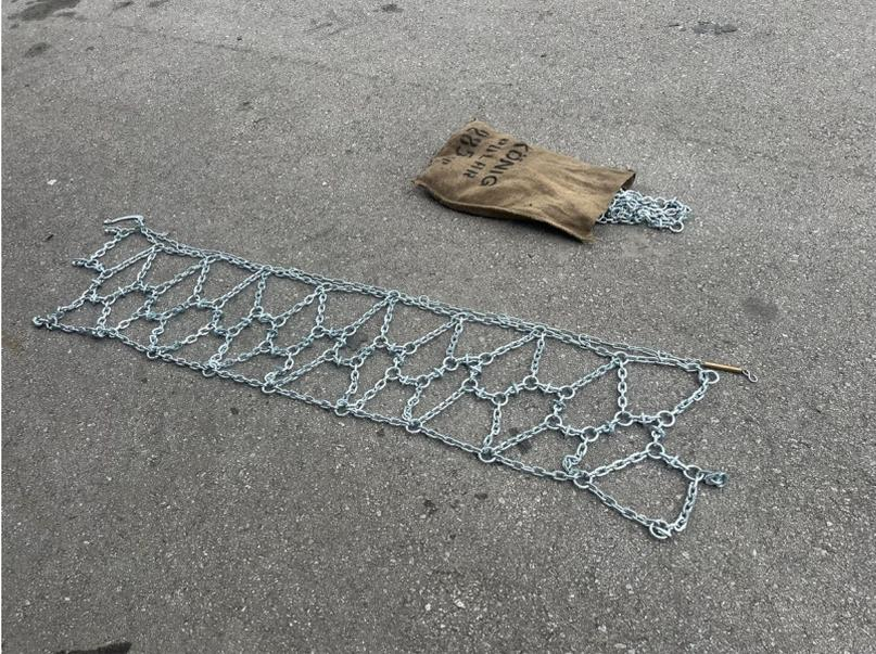
Diese Schneeketten sind nagelneu, Ausführung Netz mit Quergliedern, Gliedstärke 7 mm, passend für Staplerreifen mit Flach-Profil mit der Dimension 300-15.
