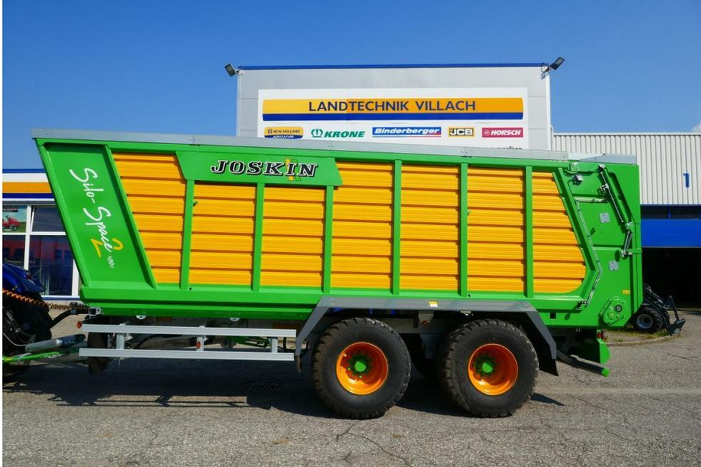
Silospace 2 480 D Abschiebewagen mit Kratzbodensystem, Zwangsgelenkte Tandemachse mit hydr. Fahrwerk, Kugelkopf Anhängervorrichtung, mit Kugelkopf K 50, Zwangslenkung, gefederte Deichsel, Bereifung: 710/50R26,5, seitlicher Auffahrschutz, mit 40 km/h Zulassung, elektrische Komfortbedienung, prompt verfügbar.
