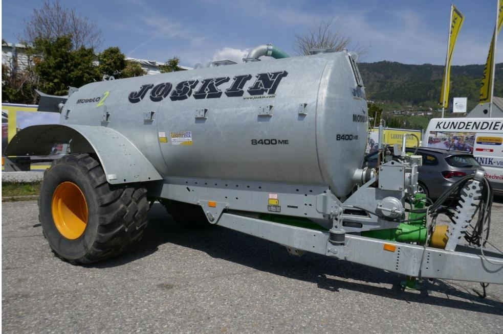
Joskin Modulo 2 8400 ME Einachs-Exzenterschneckenpumpe, zu besserer Saugleistung für tiefe Gruben, Untenanhängung mit Deichselfederung über Silentblöcke, 2 Blindflansche 8 Zoll beidseitig und ein Ansaugschieber 6 Zoll, Füllstandsanzeiger, hydraulischer Stützfuß, Radkasten, Bereifung: 710/50R26,5, Prallkopfverteiler, hydraulische Bremse, Beleuchtung, 4 m Ansaugschlauch 6 Zoll, neuwertiger Zustand, sofort verfügbar
