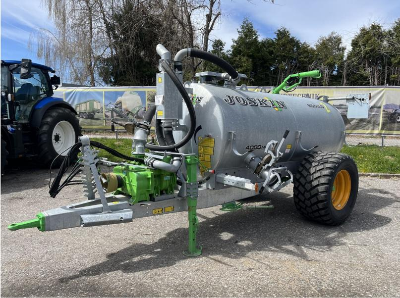
Joskin Modulo 2 4000 Liter, mit Garda Hochdruckpumpe und Weitwurfdüse, hydraulisch verstellbar, Bereifung: 560/45-22.5, hydraulische Bremse, einseitige Weitwinkelgelenkwelle, Füllstandsanzeiger mit Schwimmer, Glockenschieber, 2. Ansaugschieber, 3 m Spiralschlauch und 3 m verzinktes Rohr, mit Perrot-Kupplung, Exaktverteiler, Senkrechtorientierung der Weitwurfdüse durch Hydraulikzylinder, Ausstellungsfass, prompt verfügbar.
