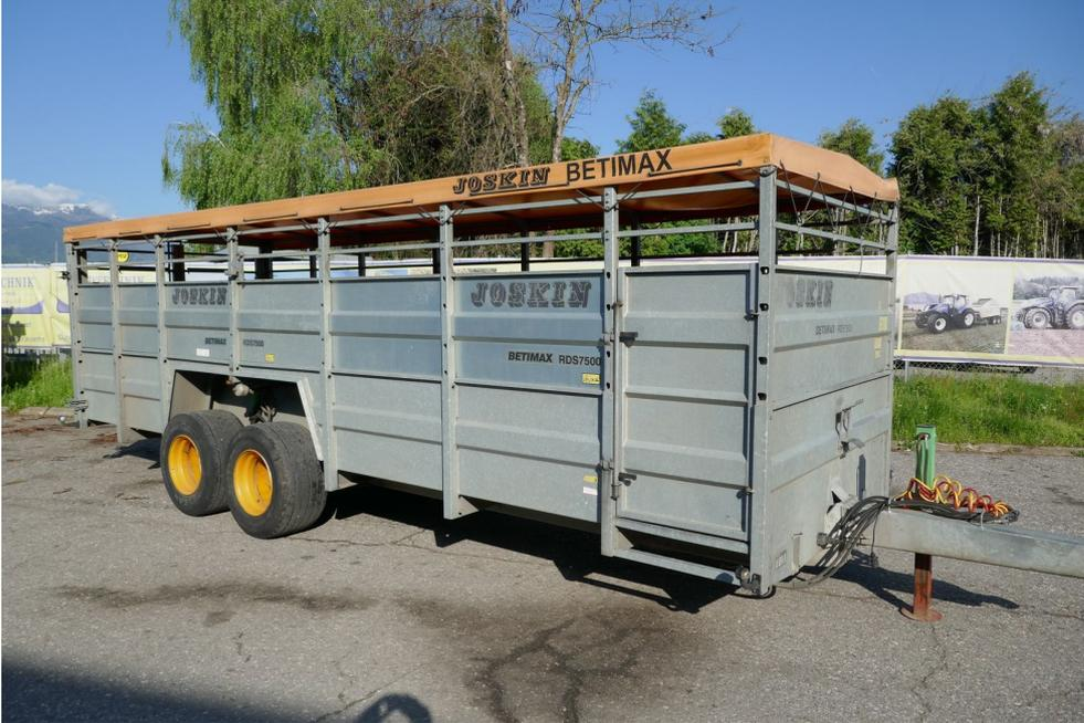
Joskin Viehanhänger RDS 7500, hydraulisch absenkbar, mit Tandemachse, vollverzinkte Ausführung mit Kunstharzboden, einteilige innere Trennwand mit 3 Einstellmöglichkeiten, Bereifung 435/45R-19.5 mit Druckluftbremse, vordere Einstiegstür, Dachplane, Doppeltür hinten, Beleuchtung, hydraulischer Stützfuß, prompt verfügbar.
