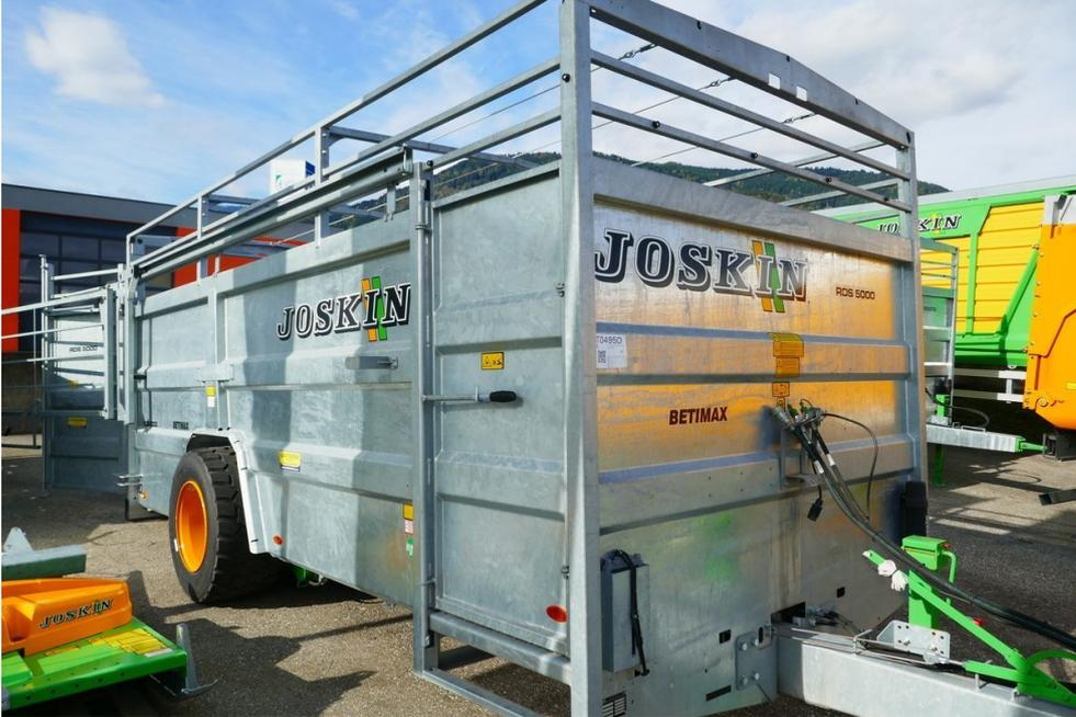
Joskin RDS 5000 hydr. absenkbar, Viehanhänger mit Planenaufbau, innere Trennwand verstellbar, Kunstharzboden, vordere Einstiegstür, Bereifung: 445/45R19,5, hydraulische Bremse, feuerverzinkte und selbsttragende Seitengitter von 3,5 m auf Führungsschiene mit Federung, feuerverzinkter Anhänger, gefederte Deichsel, ideal für das Tierwohl und Langlebigkeit, Schulungsanhänger, Lieferung nach Vereinbarung.
