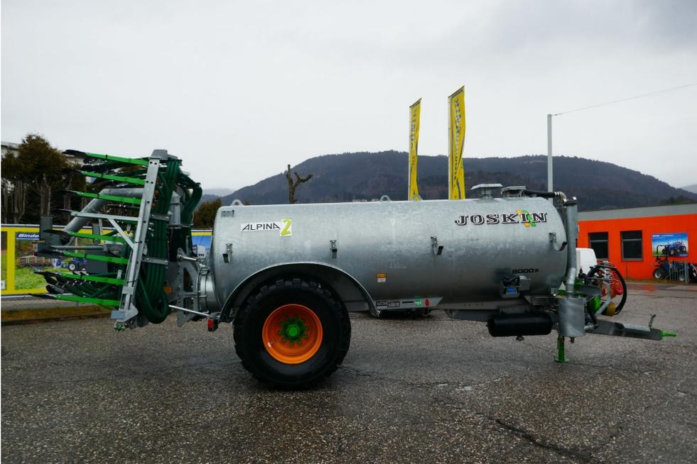
Joskin Alpina 2 8000 Vakuumfass mit Schleppschuhverteiler Pendislide Basic 75/30 mit elektrischer Komfortbedienung, mit Pumpe 8000 MEC, automatische Schmierung, Öko-Siphonabscheider, Bereifung: 800/45R26,5, Kombibremse mit Druckluftbremse mit ALB am Füllstandsanzeiger und Hydraulische Bremse, Glockenschieber, zweiten Sauganschluss, Ansaugschlauch 4 m &#34; Perrot, zusätzlich mit Exaktverteiler, Weitwinkelgelenkwelle, Ausstellungsfass, prompt verfügbar!
