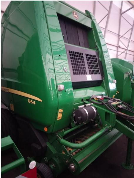
Sehr gepflegte Rundballenpresse, nur Heu und Stroh gepresst, Druckluftanlage, Maxicutrotor mit 14 Messer, absenkbarer Boden, Netzbindung Cover Edge, Weitwinkelgelenkwelle, Ballendurchmesser 60 bis 180 cm, Weichkerneinrichtung, Bale Trac Monitor
