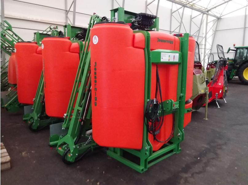
3 Punkt Feldspritze, Star Ligth Gestänge 15 Meter, Computer Bravo 400 S, hydr. Vorwahlschaltung li/re/höhe, Balken Beleuchtung weiss,
