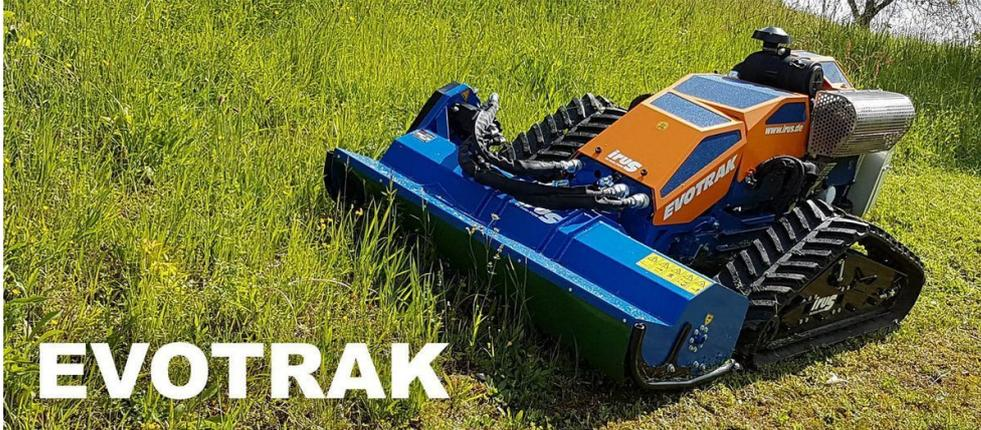
Irus Evotrak , 27 PS Benzinmotor , Mulcher 100cm Arbeitsbreite
