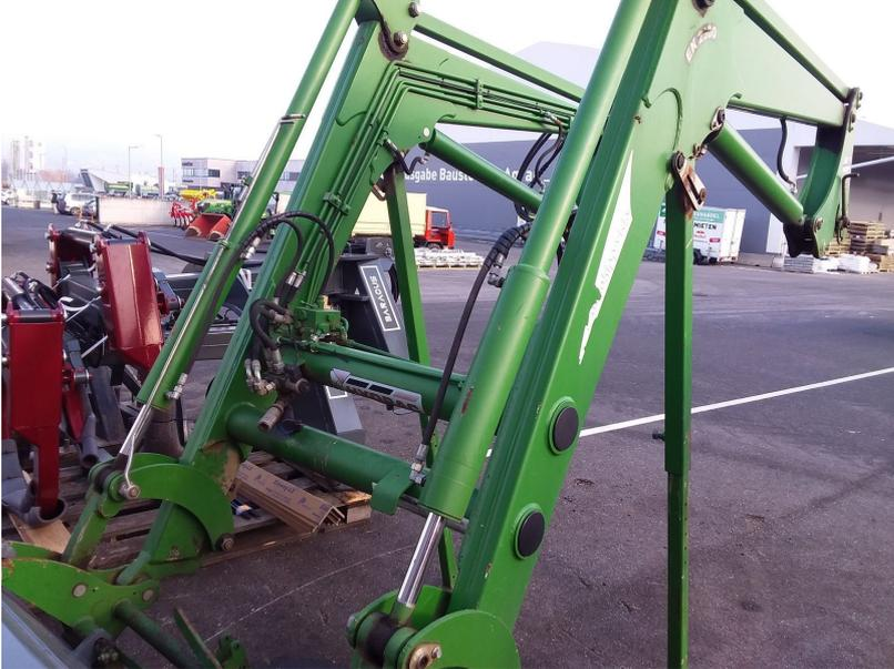
Mit Konsole passend für 6010/6020/6030 Premium und Standart John Deere Traktoren, 3. Ventil, Parallelgeführt, Euroaufnahme,
