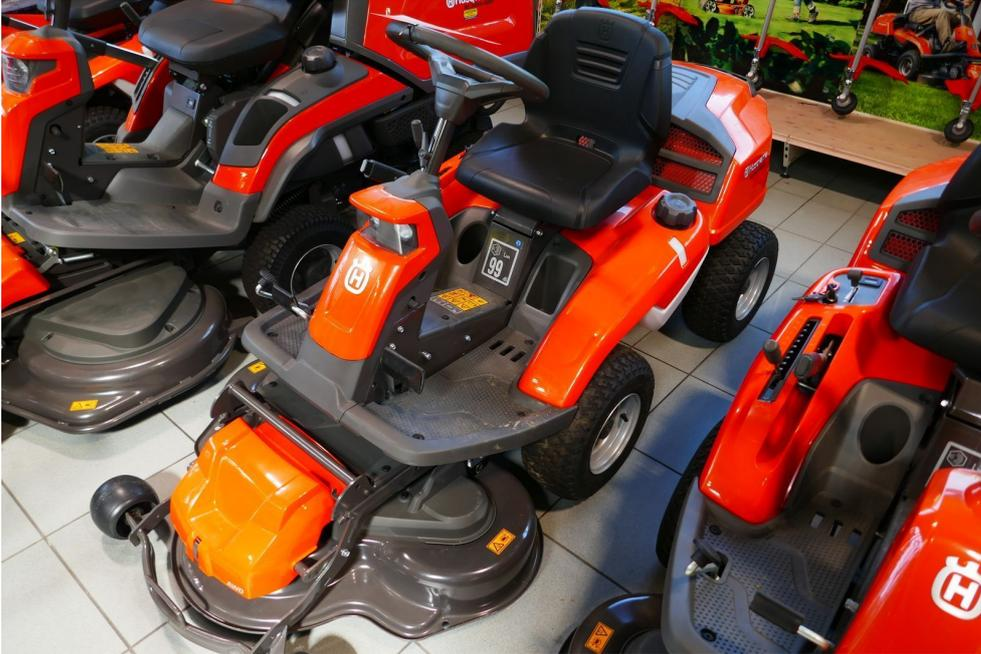
Husqvarna Rider R 216T AWD Allrad, Husqvarna Motor HV 586AE, 16 PS/12kW mit 2900 U/min, Combi Mähdeck 103 cm, Allradantrieb, Hydrostat, verstellbares Lenkrad, automatische Messerzuschaltung, LED-Scheinwerfer, Stauraum und Flaschenhalter, Betriebsstundenzähler, Turn Key Start, Husqvarna Connect, prompt verfügbar.
