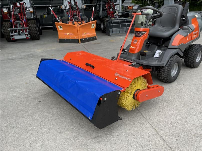
Husqvarna Frontkehrmaschine, Kkehrbürste mit 120cm Arbeitsbreite, geschwenkt 100cm, Robuste Ausführung, super geeignet zum Kehren von Sand, Kies, Laub und Schnee, inkl. Sammelwanne leicht gebraucht.
