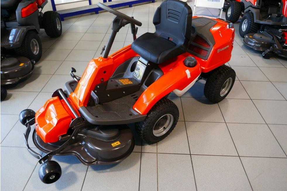
Husqvarna Rider 214 C mit HS 413AE Motor, Leistung: 8,4 kW / 11,5 PS, 3.000 U/min, Gewicht ohne Mähdeck: 228 kg, Mähdeck: 94 cm, Ausstattung: Hinterachslenkung, autom. Messerzuschaltung, Hinterradantrieb, Flaschenhalter, Hydrostat, Mähdeck mit 3 Messern, Stundenzähler, Turn Key Start, Ausstellungsgerät, prompt verfügbar. Abholpreis.
