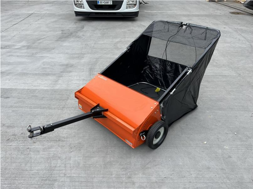
Husqvarna Rasenkehrmaschine ca. 0,9m Arbeitsbreite, mit ca. 500l Sammelbehälter, 7-Stufige Einstellung, ideal zum Sammeln von Laub & Rasen. im Video ist ab Minute 2 die Rasenkehrmaschine in Aktion zu sehen.
