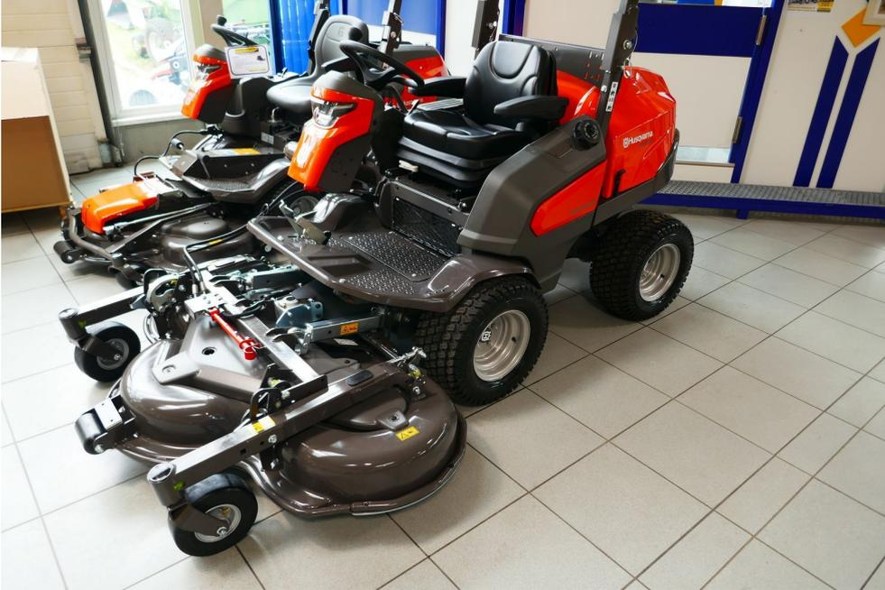
Husqvarna Profi-Rider P525 DX mit Kubota Dieselmotor, Leistung 24 PS @ 3.000 U/min., hydrostatischen Antrieb, Allradantrieb, Mähdeck Combi 155X cm, hydraulischer Schnitthöhenverstellung und hydraulischer Aushebung, Servolenkung, Hinterachslenkung, integrierte Konnektivität, in unserer Ausstellungshalle neu eingetroffen, prompt verfügbar. Auch Finanzierungsmöglichkeit.
