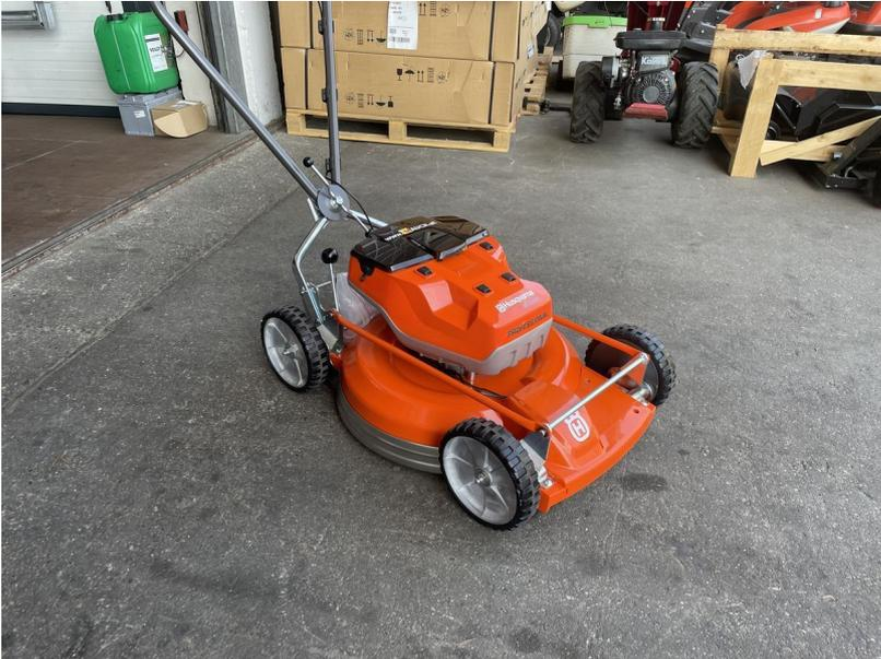
Husqvarna Mulchmäher LB553iV Profimäher, Gummireifen, aktive Akkukühlung, zentrale Höhenverstellung, Alufelgen, Option für Rückenakku ist dabei, robustes Aluminium Gehäuse.
