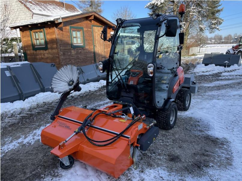
Kehmaschine Bema Kommunal Dual 1250 oder 1400mm breit, mit hydraulischer Sammelwanne, mechanischer Schwenkeinrichtung, Spindel für die Höhenverstellung der Kehwalze, mit Husqvarna Diesel Rider Aufnahme, optional mit Seitenbesen.
