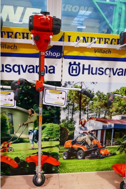
Husqvarna 545 RXT, 45,7 cm<sup>3</sup> Hubraum, 2,2 kW / 3,0 PS, 8,6 kg, Einfach-Start, Kraftstoffpumpe, LowVib, mit Tragegurt + 3 Zackmesser + Trimmerkopf, prompt verfügbar.
