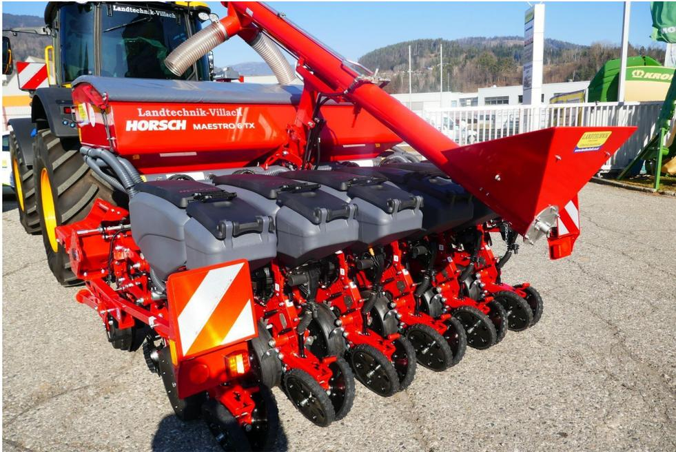
Horsch Maestro 6 TX hydraulisch verschiebbare Reihenweiten von 45 bis 80 cm mit Düngerstreuer mit Befüllschnecke und Mikrogranulatstreuer, überzeugt die Maestro TX durch universelle Einsatzmöglichkeiten, für Mais, Soja, Sonnenblumen, Raps, Hirse usw., das AirSpeed Dosiersystem sorgt für absolut präzise Ablage und Korneinbettung, hydraulische Schardruckverstellung, bei höchster Geschwindigkeit im kompakten 3-Punkt Segment, ohne Terminal mit ISOBUS-Steuerung, prompt verfügbar.
