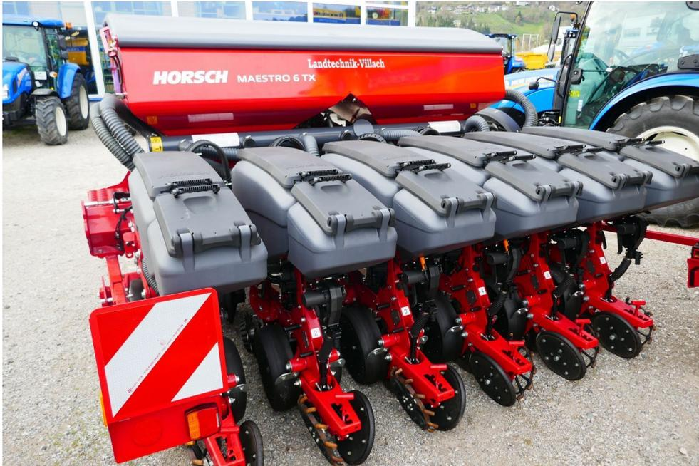
Horsch Maestro 6 TX hydraulisch verschiebbare Reihenweiten von 45 bis 80 cm mit Düngerstreuer und Mikrogranulatstreuer, überzeugt die Maestro TX durch universelle Einsatzmöglichkeiten, für Mais, Soja, Sonnenblumen, Raps, Hirse usw., das AirSpeed Dosiersystem sorgt für absolut präzise Ablage und Korneinbettung, hydraulische Schardruckverstellung, bei höchster Geschwindigkeit im kompakten 3-Punkt Segment, ISOBUS-Steuerung, Vorführmaschine, prompt verfügbar.
