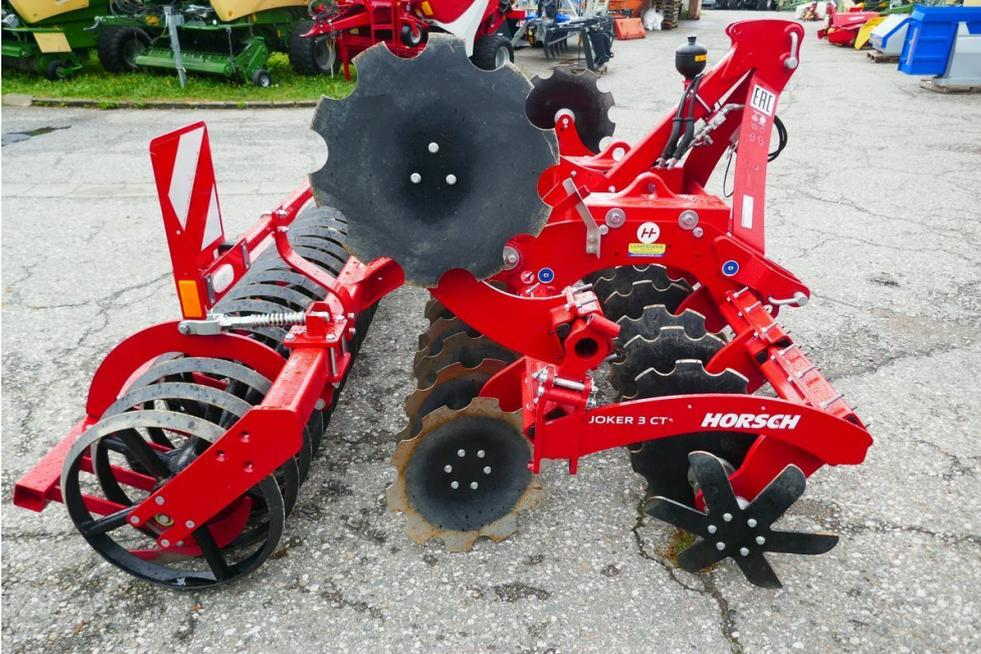
Horsch Scheibenegge 3 CT, 3 m Scheibeneggen, Randscheiben, hydr. Tiefenverstellung mit Speicherblase, Beleuchtung, Rollcut Packer Walze, Zusatzgewichte 400 kg, Striegel, Vorführmaschine, prompt verfügbar
