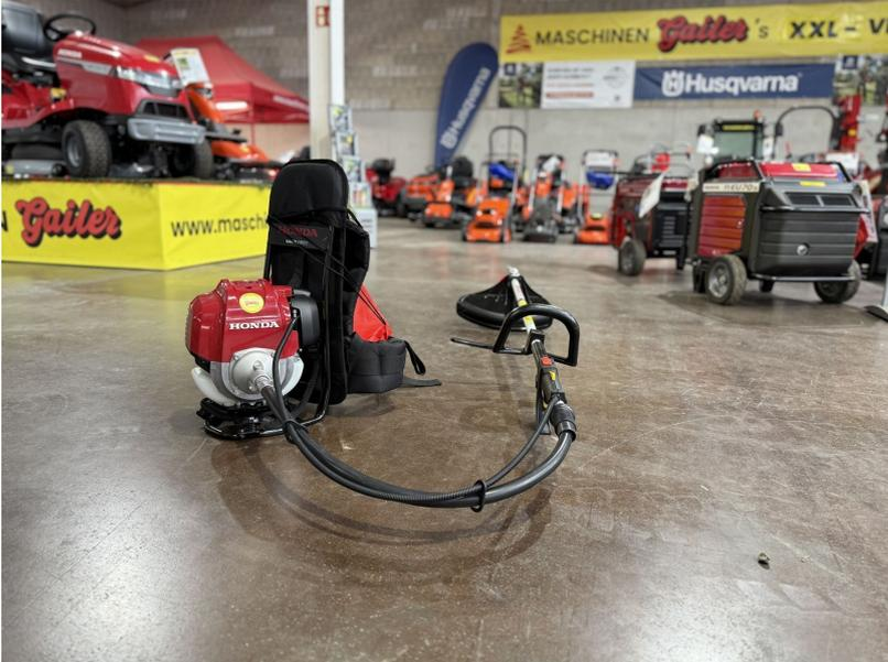
Honda Rucksack-Freischneider UMR 450T mit 50 cm<sup>3</sup> 4-Takt-Motor (GX50). Leistungsstark, vibrationsarm und ideal für anspruchsvolle Gartenarbeiten wie Grasschneiden und Gestrüppbeseitigung. Mit Komfort-Tragegurt, starrem Schaft und flexiblem Schneidkopf für optimale Manövrierfähigkeit. Leichtstart durch Dekompressionssystem, sparsamer Kraftstoffverbrauch, geringe Emissionen. Zustand: Top, wenig genutzt. Abholung in [Ort einfügen] oder Versand möglich. Kontakt: [Ihre Kontaktdaten].
