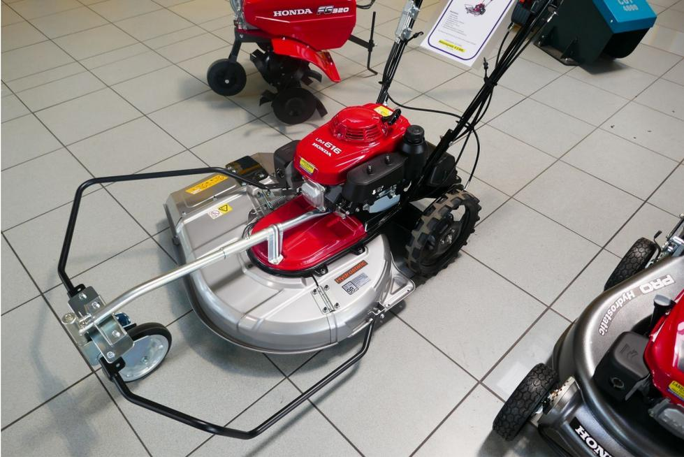
Honda Hochgrasmäher mit 4-Takt OHV Motor GVX160, 61 cm Schnittbreite, Schnitthöhe von 20 -80 cm, Hydrostat Antrieb stufenlos, 4 Positionen Schnitthöhenverstellung, Gewicht: 72 kg, Schallpegel: 98 dB(A), Mulchsatz: Seitenauswurf, mit Handbremse, Messerkupplung, prompt verfügbar.
