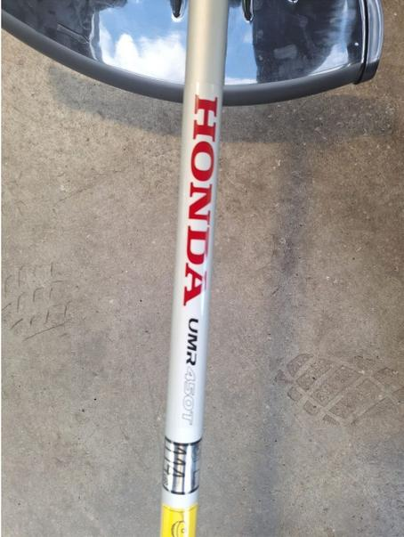
Rückentragbare Motorsense Honda UMR 450 T , 4-Takt , GX50 Motor, Leistung: 1,47 kW, Gewicht: 10 kg, Welle: flexibel, Zubehör: Fadenkopf, 3-Zahnblatt, Tragegestell, Ausstattung: Fliehkraftkupplung, Einhandbügel, Standort: Lieserbrücke, prompt verfügbar.
