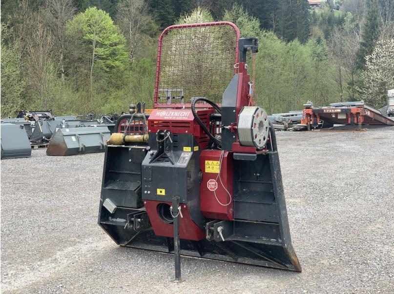
Holz-knecht Seilwinde HS 77 P mit Rückholwinde RS 500, Baujahr 2024, Schildbreite 2,10m, 120m Seil 11mm, Seil für Rückholwinde 300m 4,6mm, Umlenkset, inkl. Gelenkwelle;
