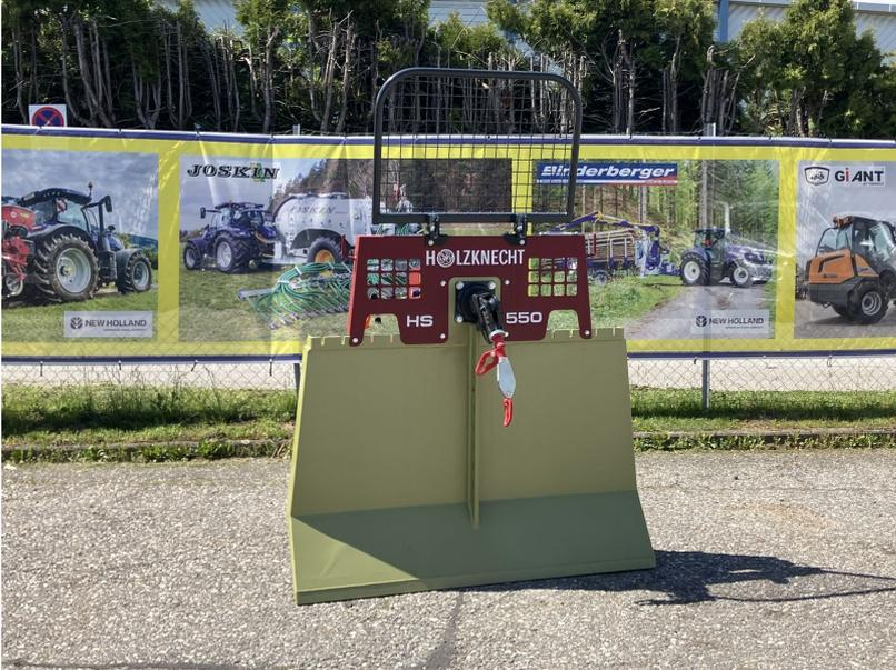
Holzkecht Seilwinde HS 550 mit hydraulischem Seilausstoß und Seileinlaufbremse, Holzkecht Funk Autec, Kipp-Stop, Gewicht ca. 370 kg, 80 m/10er geh. Seil mit Parallelhaken, Seilgleiter, Motorsägenhalter, Sapinhalter, neuestes Modell, Schildbreite: 160 cm, Schutzgitter, Standort: Lieserbrücke, prompt lieferbar.
