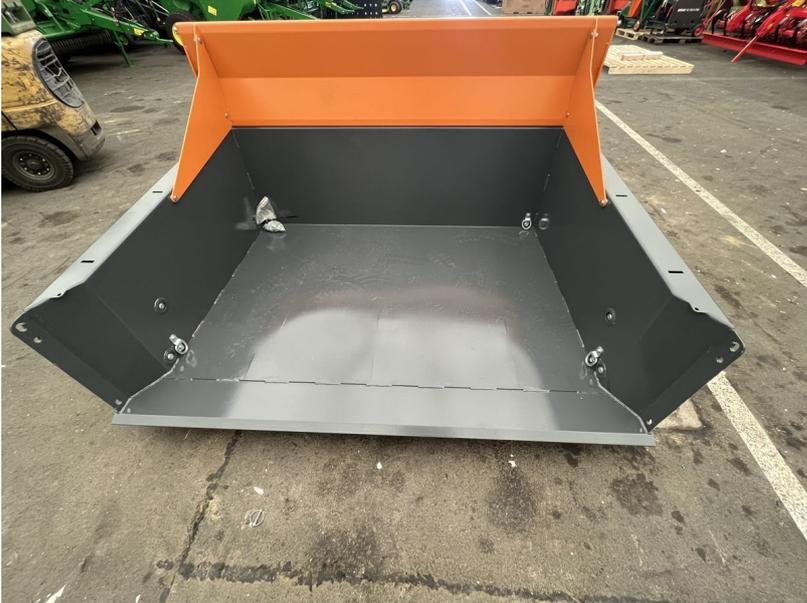
Die Kippschaufel der Marke Hauer vom Modell &#34;KM 1900&#34; ist eine hochwertige und robuste Schaufel mit einer Breite von 200cm. Sie verfügt über eine Schwenklappe und wird seitlich von 2 Hydraulikzylindern gestützt. Trotz ihrer Größe ist die Kippschaufel sehr flach und kann problemlos mit einem Hubwagen befahren werden. Mit einem Gewicht von 523kg und einer Innenbreite von 1680mm ist sie eine zuverlässige und vielseitige Lösung für verschiedenste Einsatzzwecke.
