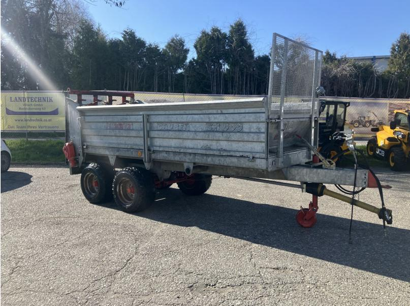
Gruber Miststreuer SM 900 mit Tandemachse, mit hydraulischer Bremse, Bereifung: 380/55-17, Streuwerk mit 4 stehenden Walzen, verzinkte Ausführung, hydraulischer Kratzbodenantrieb, Gelenkwelle, Steinschutzgitter vorne, Miststreuer sofort einsatzbereit, prompt verfügbar.
