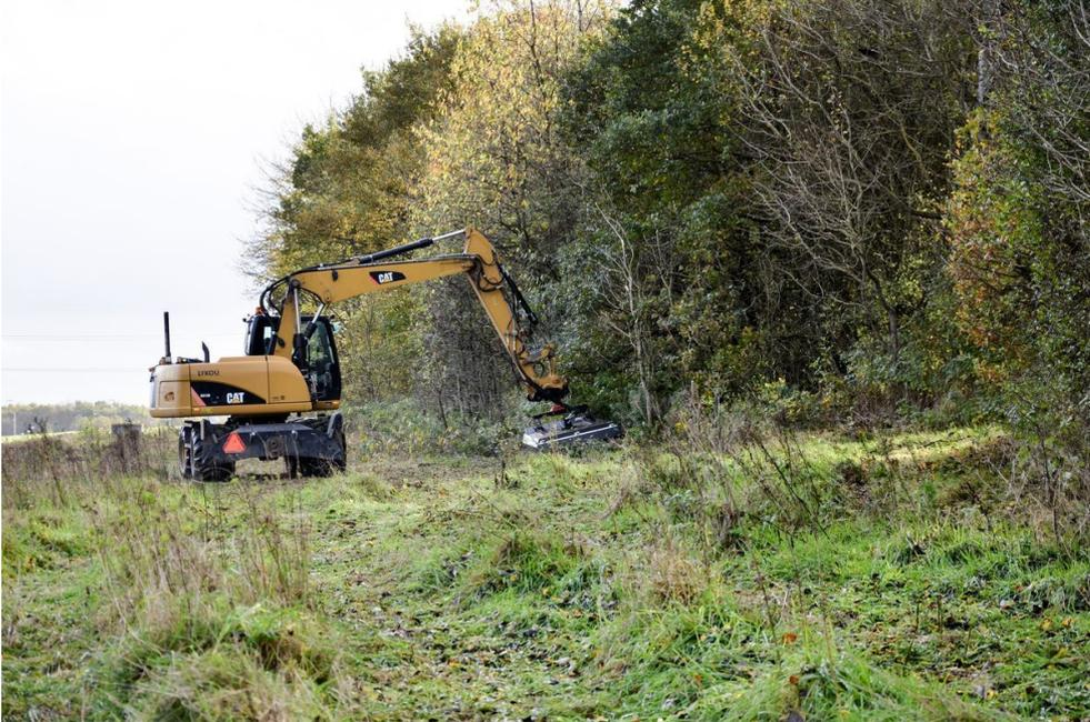
Arbeitsbreite 1,55 m, Gewicht 460kg , max. Aststärke 7 cm , min. Ölmenge 85 l/min, passend auf Ausleger oder Bagger. Das Gerät mit dem Baujahr 2020 ist gerade nicht lagernd.
