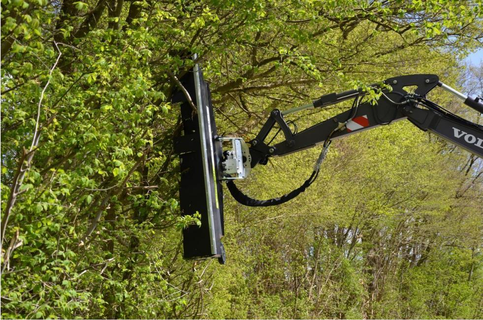
Arbeitsbreite 2,3m, Gewicht 310 kg , max. Aststärke 4 cm , min. Ölmenge 50 l/min, passend auf Ausleger oder Bagger Das Gerät mit dem Baujahr 2020 ist gerade nicht lagernd.
