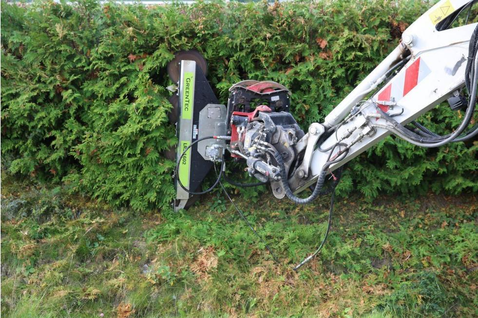
Greentec Astsäge LRS 1602 mit einer Arbeitsbreite von 1,6m, Gewicht 110 kg, max. Aststärke 12 cm, min. Ölmenge 40 l/min, passend auf HXF 2802/3302, Ausleger und Bagger.
