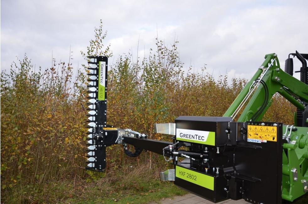
Arbeitsbreite 1,7 m, Gewicht 120kg , max. Aststärke 6 cm , passend auf HXF 2802/3302, Ausleger oder Bagger.
