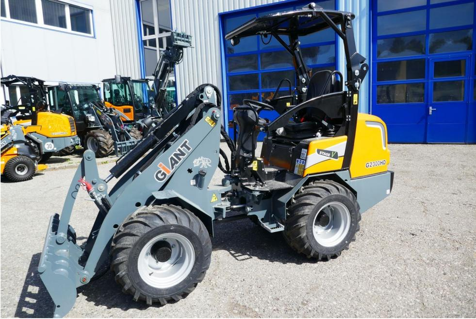
G 2300 HD Agri Line mit 4 Zyl. - Kubota Motor, Schwinde mit Euro-Aufnahme, hydraulische Werkzeugverriegelung, 3. und 4. Linie, Heckgewichtplatte 90 kg, klappbares Fahrerschutzdach, Arbeitsscheinwerfer hinten und vorne, Bereifung: 31x15.50-15 AS, verschiedene Werkzeuge als Option, ab ca. September 2025 verfügbar.
