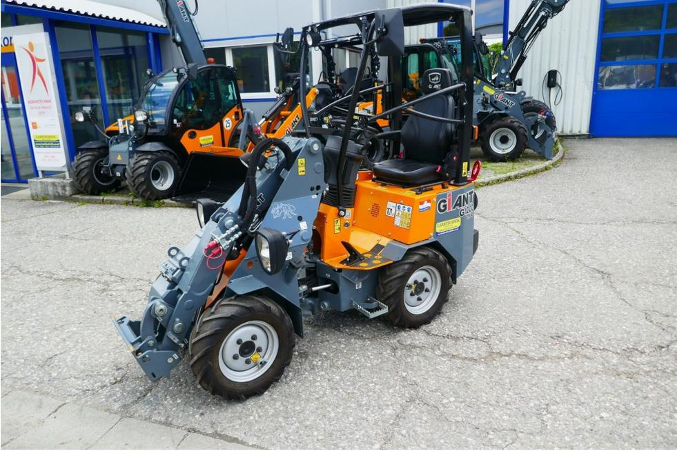
Giant G 1200 Teleskop mit Kubota Motor, Bereifung 23x8.50-12 AS, Giant Compact Werkzeugaufnahme, Heckgewichtplatte mit Zugmaul, Rops Fahrerschutzdach mit Sicherheitstür links und rechts, Arbeitsscheinwerfer am Kabinenrahmen unterm Teleskoparm, 3. Linie am Teleskoparm, Straßenverkehrsbeleuchtung, Kennzeichenbeleuchtung, optional verschiedene Werkzeuge, leichte Vorführmaschine, prompt verfügbar.
