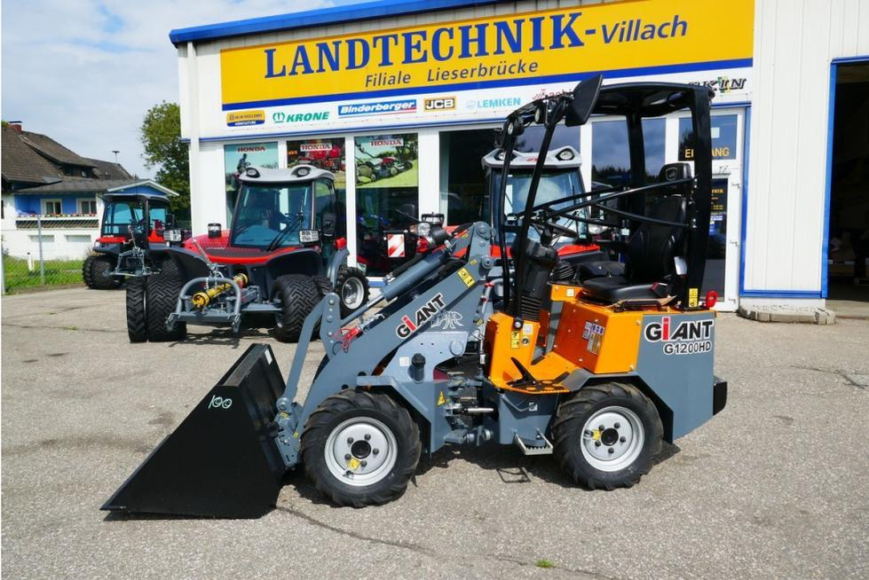
Giant Hoflader G 1200 mit Kubotamotor, 25 PS mit HD Antrieb, Bereifung: 23x8.50-12 AS, Giant Compact Werkzeugaufnahme, Heckgewichtsplatte: 70 kg, ROPS Fahrerschutzdach mit Arbeitsscheinwerfern, 1x Hydraulikkreislauf doppelwirkend am Hubarm, Option: 1 m Schaufel, Schulungsmaschine, prompt verfügbar;
